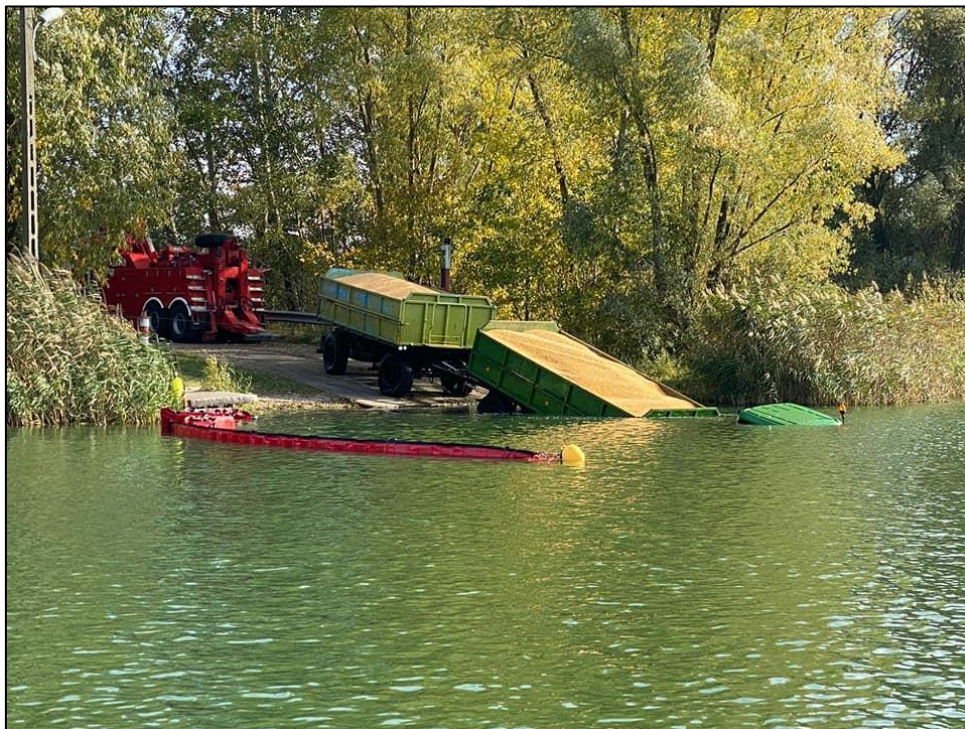
Foto. Zsunięcie się z promu ciągnika rolniczego z przyczepami z powodu zerwania liny pomocniczej. Źródło: Nadgoplańskie WOPR
